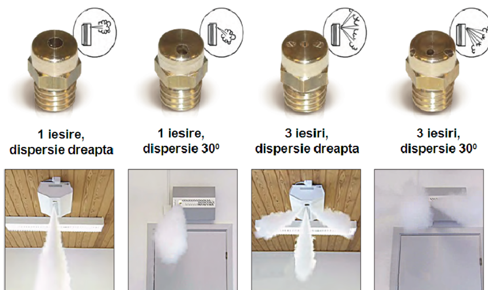
Fig. 4. Construcția și tipurile duzelor de dispersie
